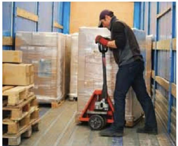
*Mit dem Niederhubwagen werden die beladenen Paletten aus dem Lkw gezogen.*
